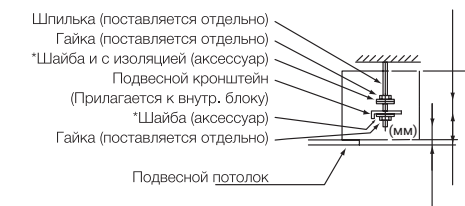
Подготовка места установки блока в подвесном потолке
